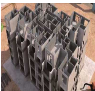
(a) 预制装配式混凝土建筑
