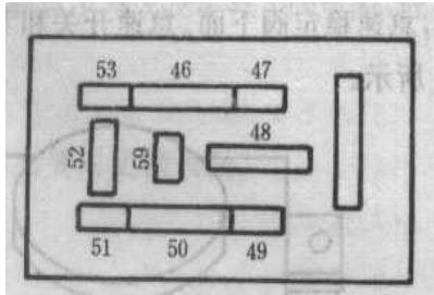
图 2 燃油泵继电器插座图
