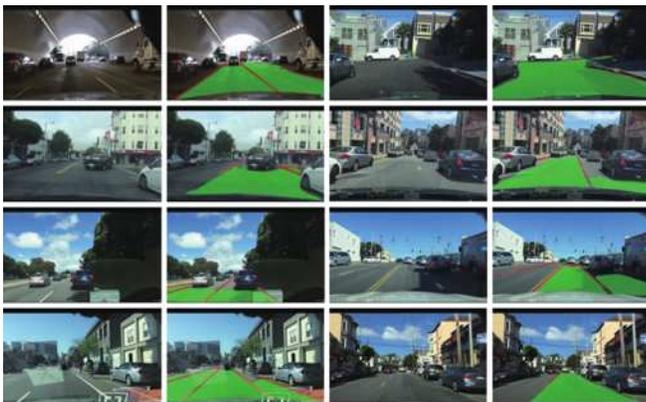
图3 车道线检测和道路区域结果示例
