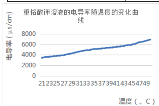
图 6 重铬酸钾溶液的电导率随温度的变化曲线
