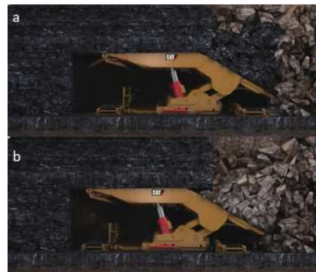
图 2 (a) 开采机工作时, 开采机身后岩层示意图; (b) 开采机前进后, 开采机身后岩层示意图。
