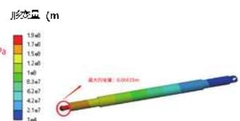
图 6 垂直撑杆形变分布云图
