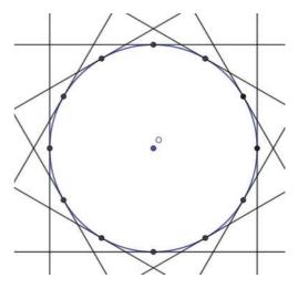
可以算出,对于半径为1的圆,外接正6边形的周长为 $6\sqrt{3}$ =10.3923048454,算出圆周率 $\pi$ 的近似值为5.1961524227,可见误差比较大,接着算出外接正12边形的周长为6.4312766184,计算的圆周率 $\pi$ 的近似值为3.2156383092,误差已经小多了,直接通过外切正786432边形算出圆周率 $\pi$ 的近似值为3.141592653589793,与内接正786432边形得到的近似值之差为0.0000000000002088,因为圆的周长介于内接和外切正多边形之间,所以就算不知道圆周率 $\pi$ 的真实值,也可以知道我们计算的误差不超过这个差。而刘徽正是利用内切外接多边形的周长的不断接近,就得到了内切和外接多边形的周长真的是以圆的周长为极限的,级不断地分割圆,会最终"无所失"。
